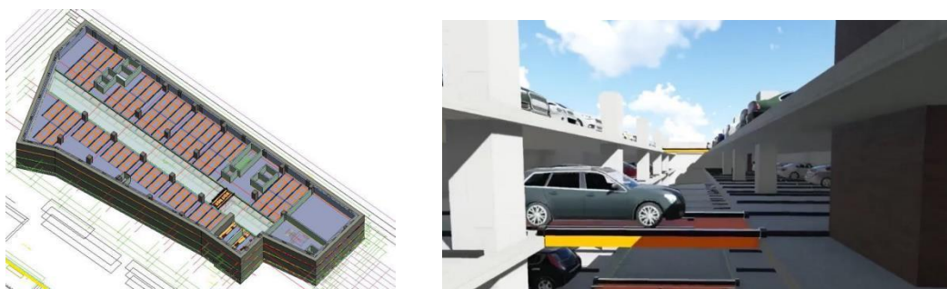
图3-6 机械车库BIM模型及取车BIM模拟
