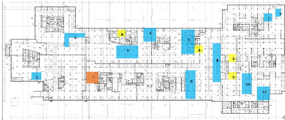
图3.6 地下室净空检查分布
