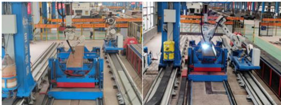
图 3.1.6-7 H 型钢焊接制作
