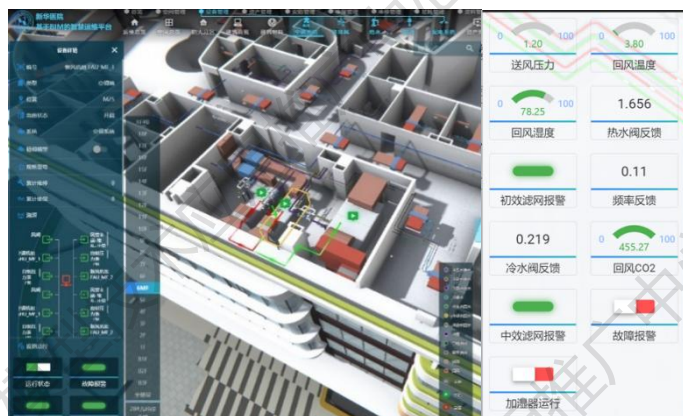
图 3.3.4-3 设备的运行参数及故障设备详情
