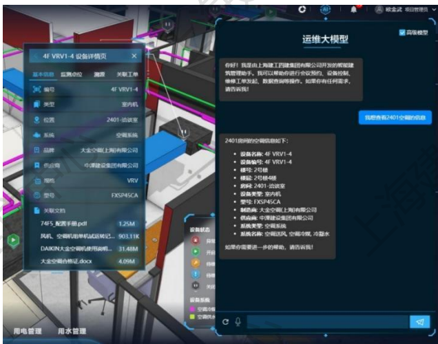
图 3.2.4-2 大模型查询 BIM 信息
