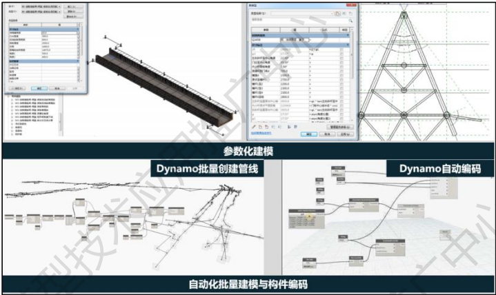
图 3.1.3-4 基于 Dynamo 的 BIM 参数化建模
