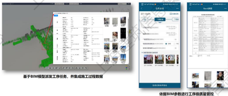
图 3.1.2-10 基于 BIM 的工序级质量管控
