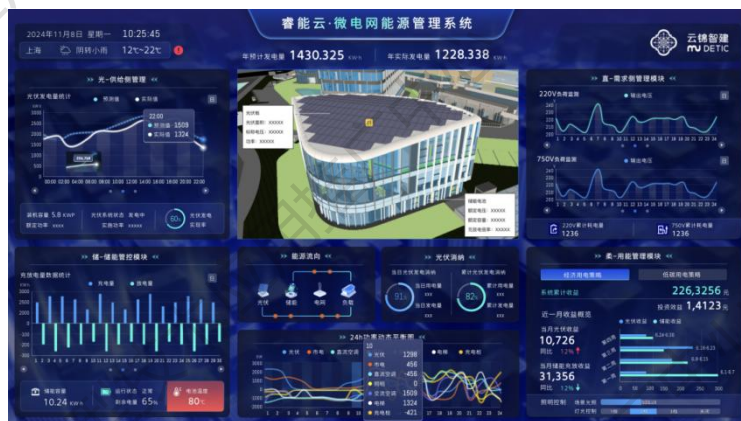
图 3.3.5-2 基于 BIM 微电网能源管理系统
