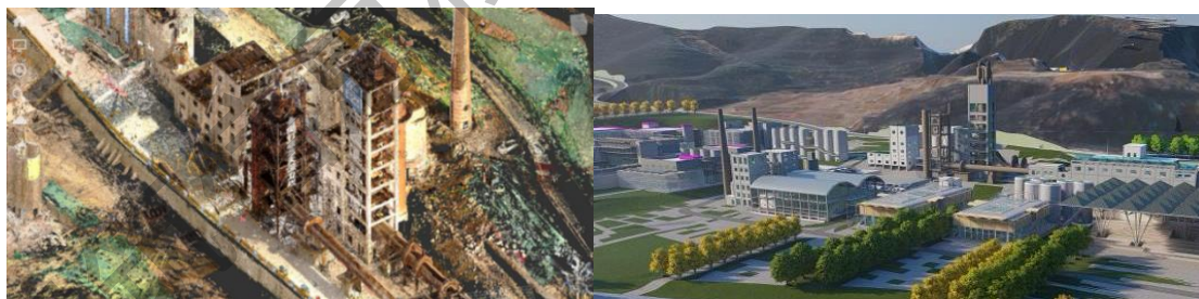
图3.1.5-1 某项目主展馆工业遗址三维激光扫描点云模型及逆向建模模型
