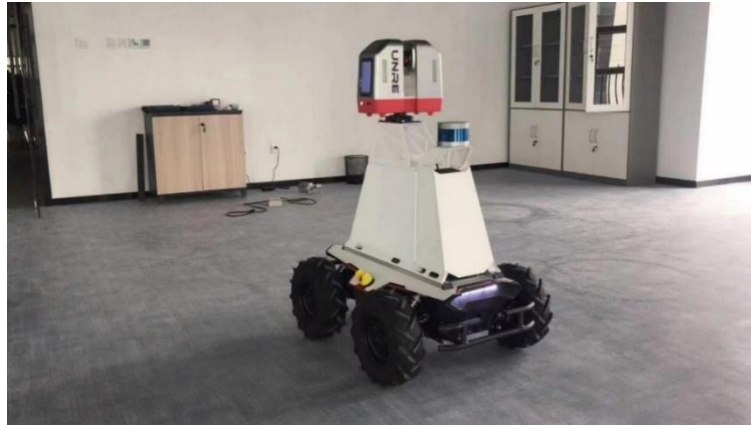
图3.3.4-4 自行走建筑智能测量机器人
