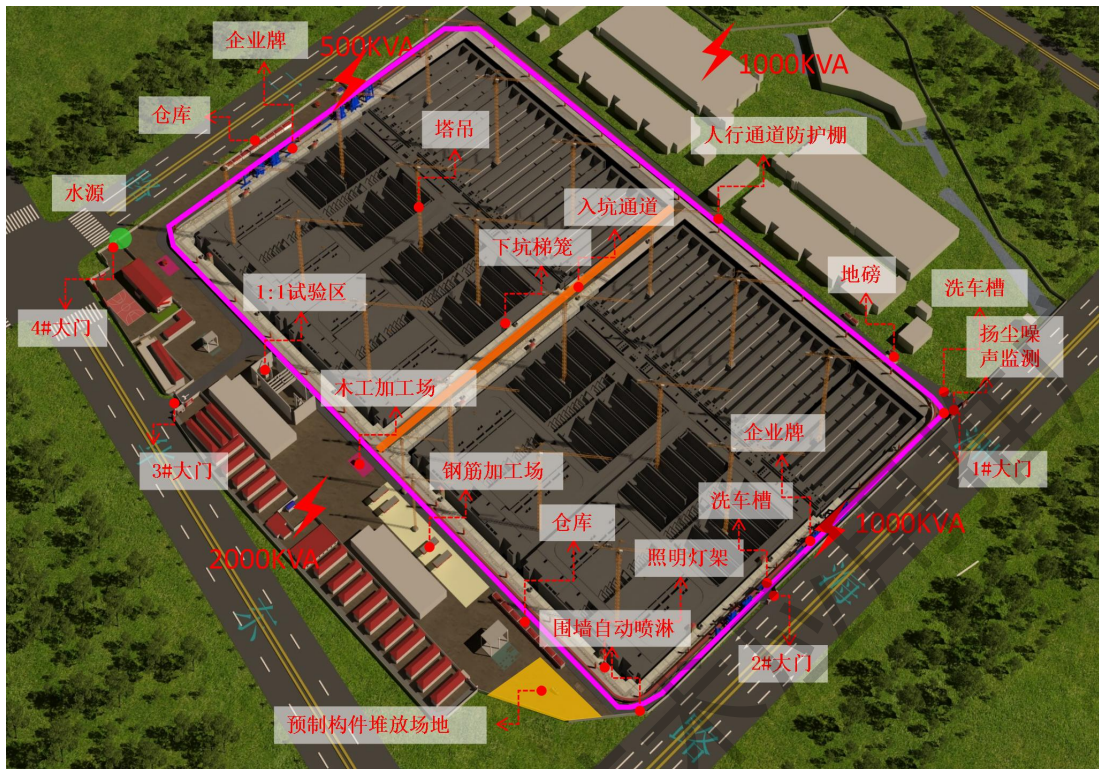
图3.1.1-24 竹园四期项目某施工场地模型图
