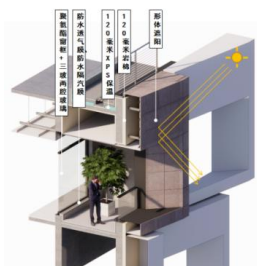
图 5.32 被动式设计原理图
